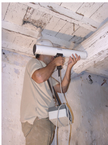
Fig. 1 - Equipamento de detecção de heterogeneidades em elementos de madeira (Resistograph).
